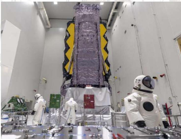
Fig. 3: Webb "ripiegato" in preparazione per il lancio
